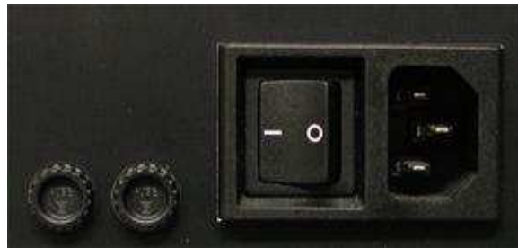
↑ ↑ ↑ ↑ Sicherungen Netzschalter Kaltgerätebuchse
