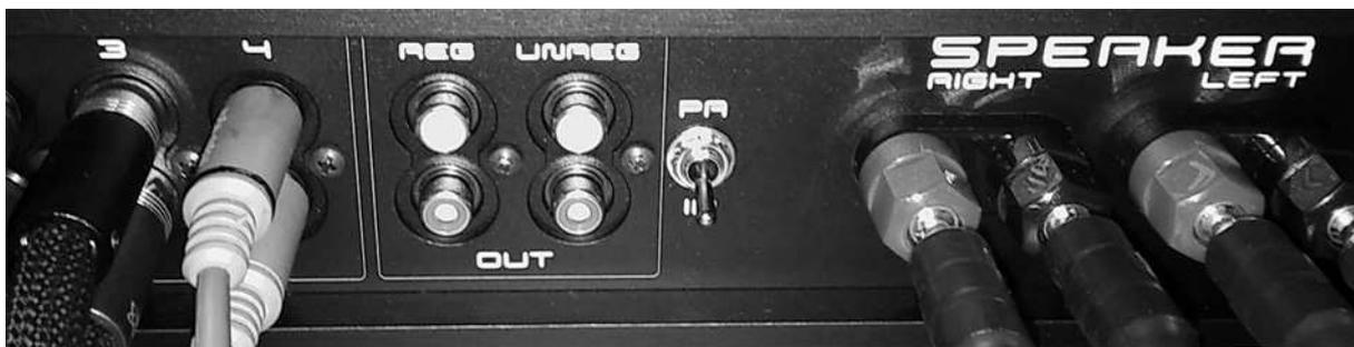
Mit dem Schalter zwischen unregulierten RCA Ausgang und den Lautsprecher-Ausgangsbuchsen kann man den CIA-1 in den Leistungs-Verstärker Modus umschalten. Der Eingang 2 wird aktiv geschaltet. Der Lautstärke-Regler wird überbrückt.
