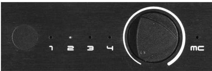
Wenn Sie den CIA-1 in den Standby-Modus schalten, wird die letzte eingestellte Kanalwahl im EEPROM gespeichert. Nach dem Wiedereinschalten startet das Gerät mit der letzten Kanaleinstellung.
